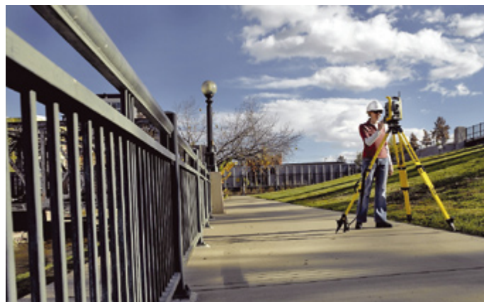
DR à longue portée – à présent on peut mesurer des cibles difficiles à atteindre ou dangereuses, aussi facilement que celles mesurées avec un prisme.
