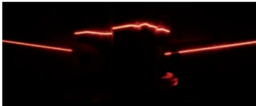
**Figure 3.** Intersection entre le plan laser et le fragment calcaire dans le noir.
